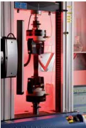
PEELING DELLE GIUNZIONI - Dinamometro.
