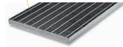
Griglia in elettrosaldato maglia 22x76, zincata
